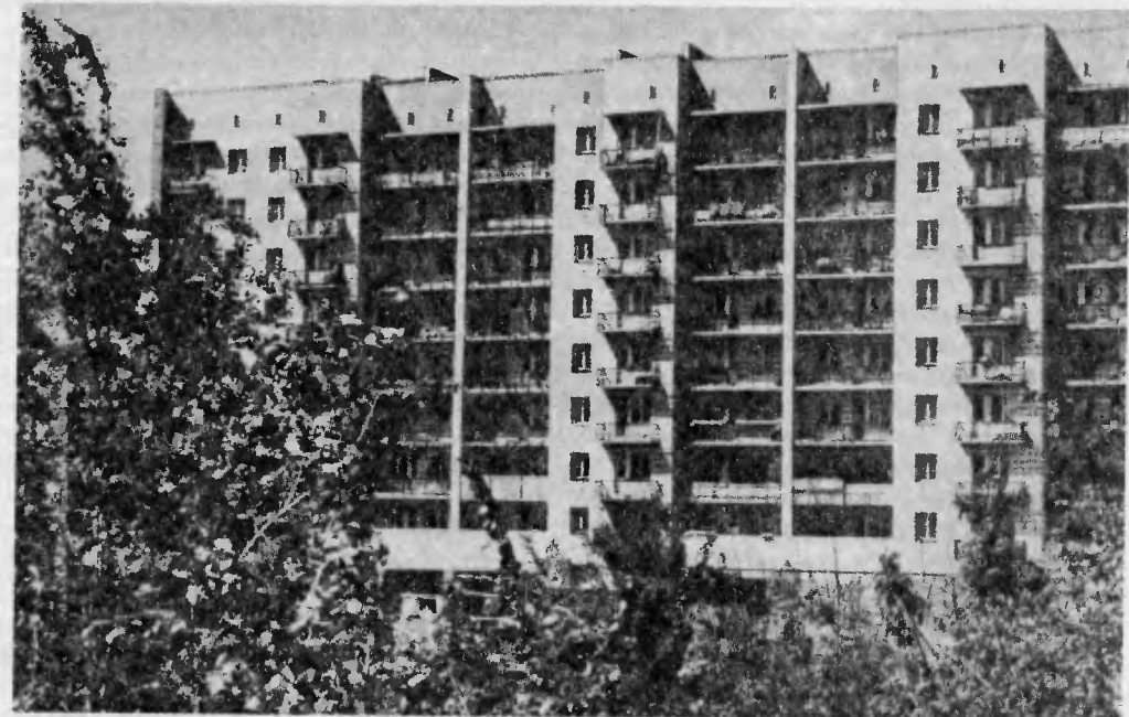
Рис. 51. Первый в нашей стране шумозащитный жилой дом с односторонней ориентацией жилых помещений — уличный и дворовый фасады (Новосибирск, ул. Гагарина, СибЗНИИЭП)
