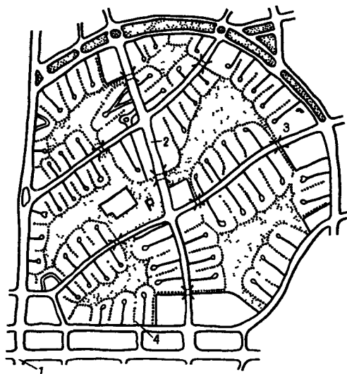
Рис. 24. Схема планировки американского города-сада Редбери (арх. Штейн, 1929 г.) 1—транспортная магистраль с транзитным движением, 2—местные проезды, 3—тупиковые подъезды, 4—пешеходные пути
